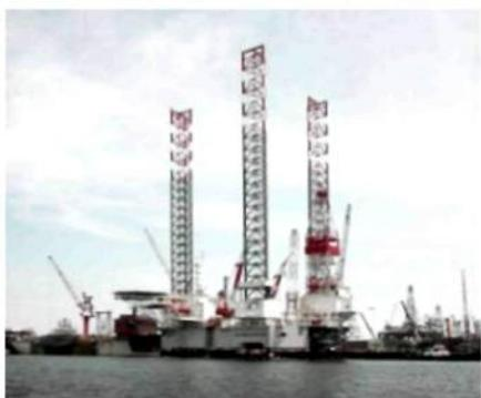
*Самоподъемная буровая установка, способная бурить скважины глубиной до 6 000 м при максимальной глубине моря 100 м.*
