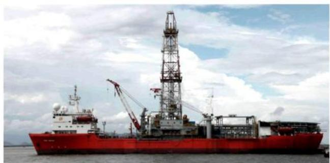
*Буровое судно, способное бурить скважины глубиной до 7 000 м при максимальной глубине моря 1 715 м.*
